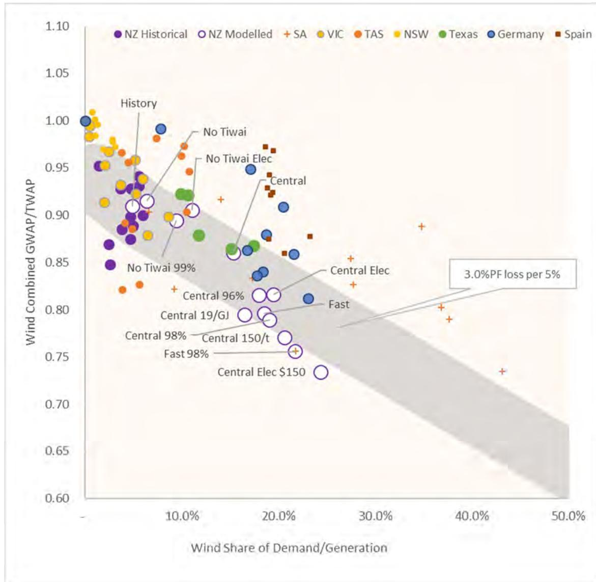
**FIGURE 4: WIND GWAP/TWAP VERSUS % WIND GENERATION**
